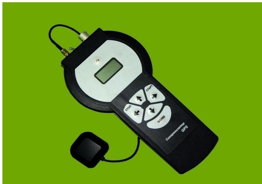
Рис. 6 Внешний вид синхронизатора GPS.
